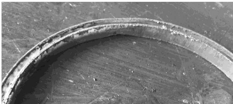
Рис. 1. Образец изношенной манжеты
