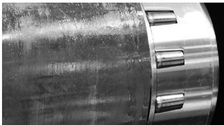
Рис. 4. Раскатная головка для электромеханического упрочнения внутренней поверхности цилиндров
